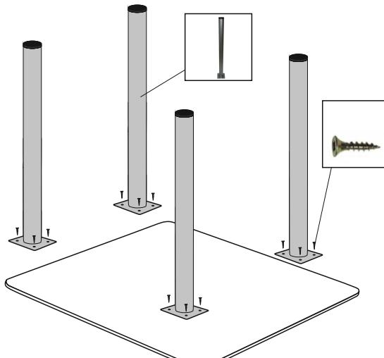
Перевернуть столешницу стеклом вниз, установить к ней опоры при помощи шурупов.
