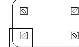
Для установки опор используйте карандаш и линейку для разметки отверстий, а также шуруповерт или отвертку.
