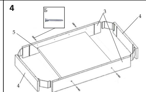
Установить ребро жесткости 5, используя конфирматы Б.
