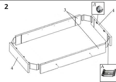
Собрать царговый пояс: соединить детали 3 и 4, используя стяжки А и шурупы Г. Установить колеса для столешницы Л.
