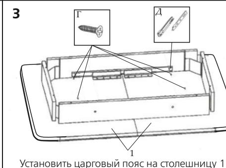
Установить царговый пояс на столешницу 1 и соединить его с механизмом Д (в сложенном и разложенном виде), используя шурупы Г. Закрепить к царгам 4 выкатные колеса Л.
