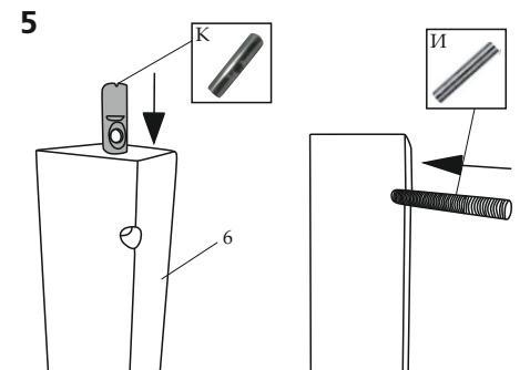
Установить вкладыш К в опору 6, вкрутить во вкладыш шпильку И.
