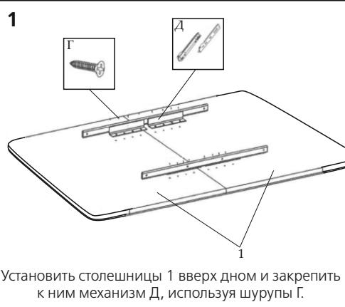
Установить столешницы 1 вверх дном и закрепить к ним механизм Д, используя шурупы Г.
