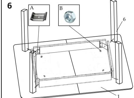
Прикрепить опоры 6, используя гайки В и стяжки А.
