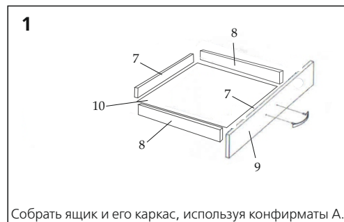
Собрать ящик и его каркас, используя конфирматы А.
