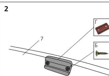
Установить подпятники Г ко дну 7 с помощью саморезов Б (могут быть установлены производителем).
