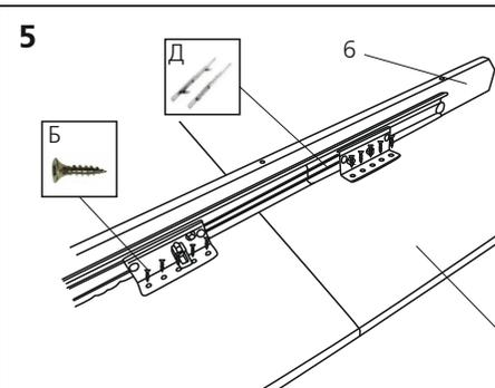
Установить на столешницу 1 планки 6 с направляющими Д с помощью саморезов Б.
