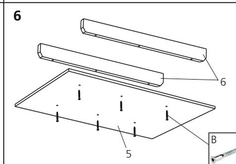
Установить собранную столешницу к собранному подстолью (закрепить снизу сквозь полку 5 с помощью конфирматов В (вид снизу)).
