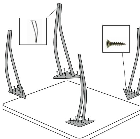
Перевернуть столешницу, установить к ней опоры при помощи шурупов.
