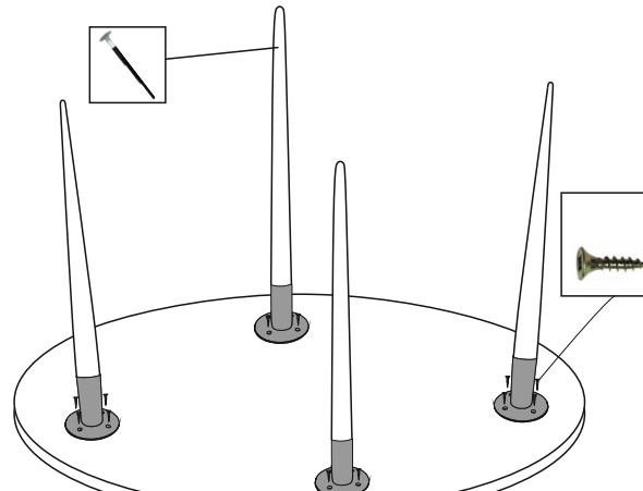
Перевернуть столешницу стеклом вниз, установить к ней опоры при помощи шурупов.
