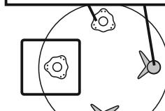
Для установки опор используйте карандаш и линейку для разметки отверстий, а также шуруповерт или отвертку.
