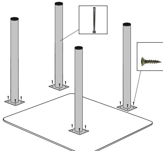
Перевернуть столешницу стеклом вниз, установить к ней опоры при помощи шурупов.
