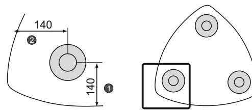
Для установки опор используйте карандаш и линейку для разметки отверстий, а также шуруповерт или отвертку.
