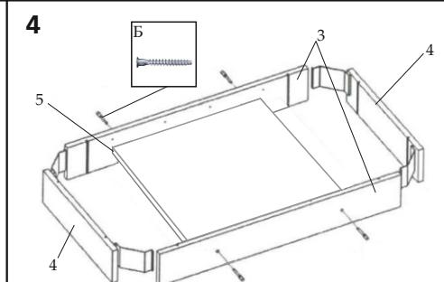
Установить ребро жесткости 5, используя конфирматы Б.
