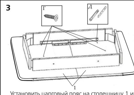
Установить царговый пояс на столешницу 1 и соединить его с механизмом Д (в сложенном и разложенном виде), используя шурупы Г. Закрепить к царгам 4 выкатные колеса Л.
