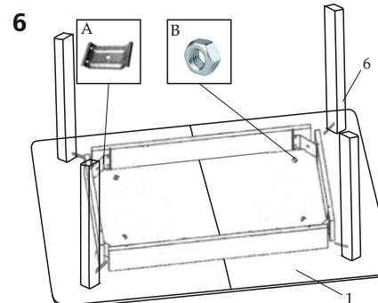
Прикрепить опоры 6, используя гайки В и стяжки А.
