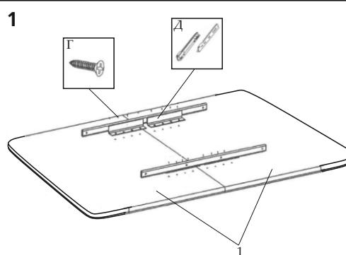
Установить столешницы 1 вверх дном и закрепить к ним механизм Д, используя шурупы Г.
