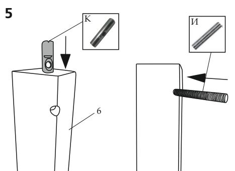
Установить вкладыш К в опору 6, вкрутить во вкладыш шпильку И.
