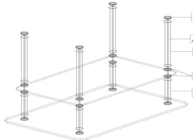
**ВНИМАНИЕ!** Производите сборку так, чтобы между стеклом и трубой находился декоративный вкладыш (шайба узла разрыва Д)
