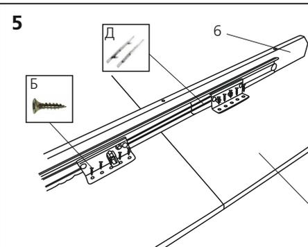
Установить на столешницу 1 планки 6 с направляющими Д с помощью саморезов Б.
