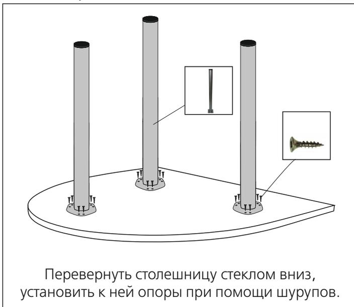
Перевернуть столешницу стеклом вниз, установить к ней опоры при помощи шурупов.
