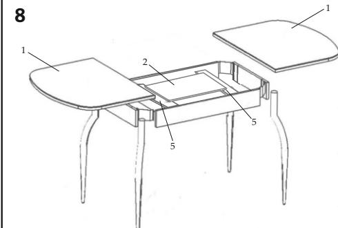
Центральная столешница 2 при необходимости убирается. Устанавливается поверх ребер жесткости 5 под основной каркас подстолья.
