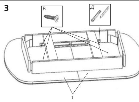
Установить подстолье стола на столешницу 1 и соединить его с механизмом Д (в сложенном виде) с помощью шурупов В.
