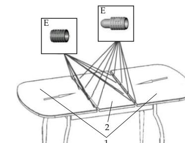
Металлический шкант Е вставлять в отверстия в торце столешниц, шканты Е устанавливаются комплектами (шкант со штырем в столешницу правую 1, ответная часть в столешницу левую 1, в центральную столешницу 2 установить ответные части, напротив.
