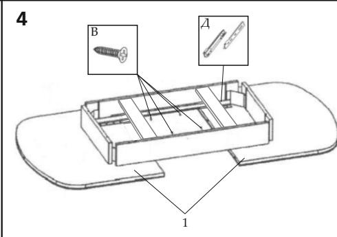
Раздвинуть детали столешницы 1 в стороны и соединить их с механизмом Д (в разложенном виде) с помощью шурупов В.
