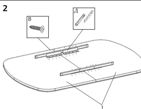
Установить к столешницам 1 раздвижной механизм Д, используя шурупы В.
