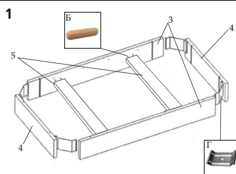
Собрать подстолье: соединить детали 3, 4 и 5 с помощью кронштейна Г и шкантов Б.
