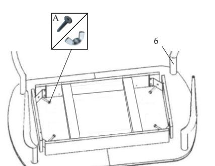
С помощью винтов А/гаек А прикрепить опоры D40/МТ, МТ-1 или МТ-2 соответственно к стяжкам Г в соответствии со схемой.
