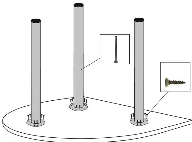
Перевернуть столешницу, установить к ней опоры при помощи шурупов.
