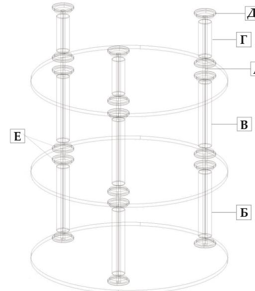
**ВНИМАНИЕ!** Производите сборку так, чтобы между стеклом и трубой находился декоративный вкладыш (шайба узла разрыва E)
